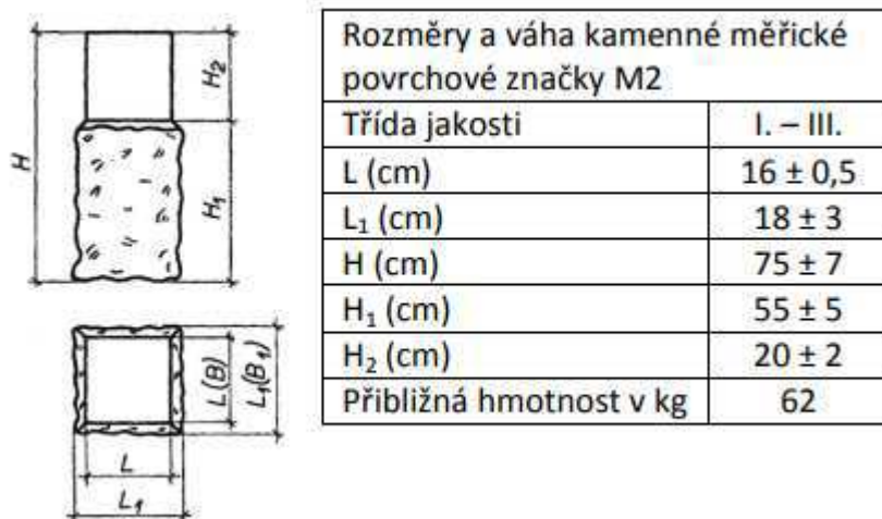
Obrázek 5 Rozměry povrchové kamenné značky M2
